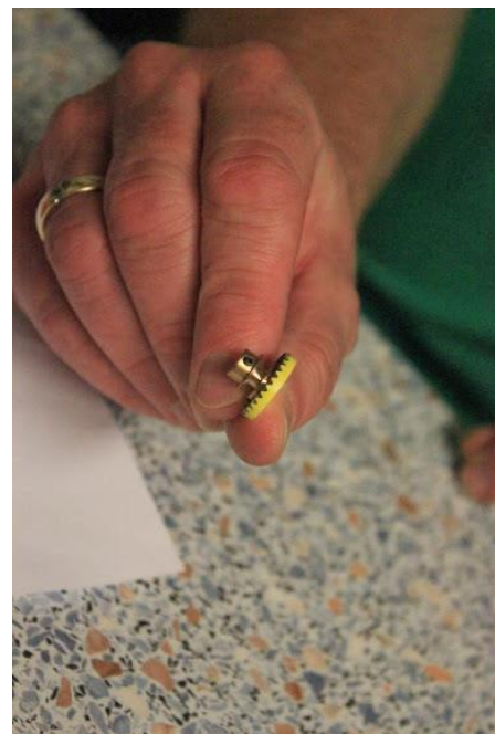
Zerschlissenes Kronrad nach 6h-Rennen auf Moosgummi. Wird uns mit unseren Reifen nicht passieren ☺
